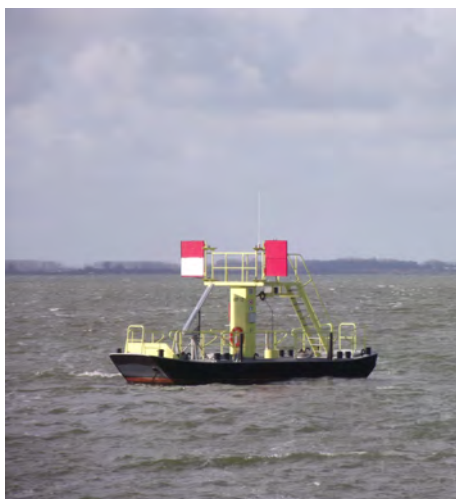
Uitgelegde meetvloten die op drie hoogten in de waterkolom het chloridegehalte meten.
